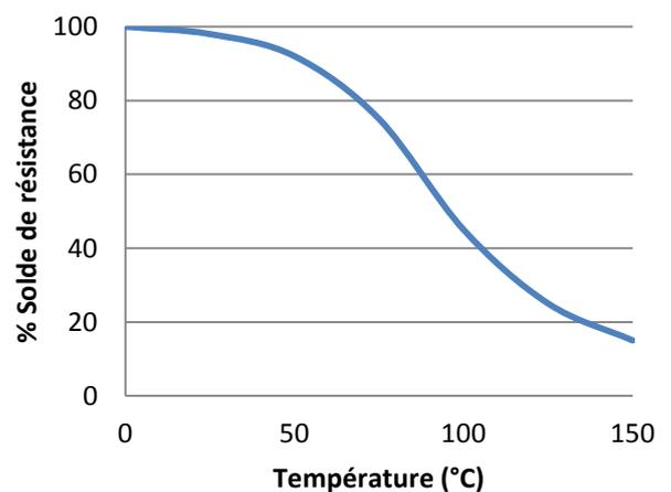
Essais en cisaillement à chaud réalisés sur des assemblages verre sur acier doux. Les échantillons sont entièrement polymérisés avant d'être mis en température pendant 30 minutes avant réalisation des essais. UV640 peut être soumis sous faible contrainte mécanique à des températures plus élevées. Par exemple Thermo-laquage, soudage. Température minimale après polymérisation: -55°C (-65°F) dépendant des matériaux.
