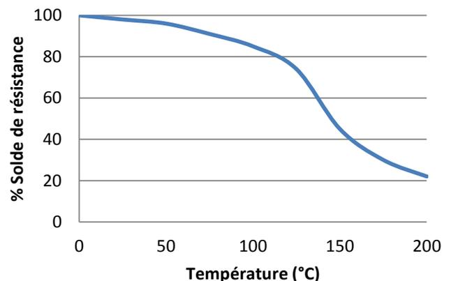
Essais de cisaillement en température réalisés sur l'acier doux. Les échantillons sont entièrement polymérisés avant d'être mis en température pendant 30 minutes avant réalisation des essais. ES569 peut être soumis sous faible contrainte mécanique à des températures plus élevées. Par exemple thermodurcissage, soudage. Température minimale après polymérisation: -40°C (-40°F) dépendant des matériaux.
