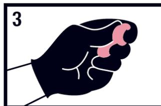
Malaxer le produit pendant 2 minutes (utiliser des gants légèrement humides pour manipuler la pâte) jusqu'à l'obtention d'une pâte de couleur homogène et sans marbrure.
