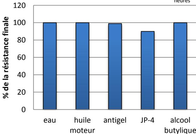
**Ce produit n'est pas recommandé pour une utilisation en contact avec de la vapeur d'eau, des substances fortement oxydantes ou des solvants polaires, bien qu'il puisse résister à des nettoyages au solvant sans détérioration de ses propriétés adhésives.**
