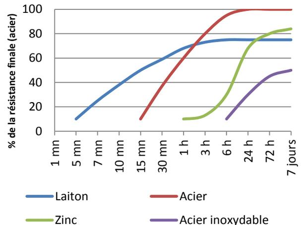
Ces données sont typiques pour des surfaces acier à 23°C. Le cuivre et les alliages cuivreux donnent une polymérisation plus rapide. Les surfaces oxydées ou passivées ainsi que le zinc donnent une polymérisation plus lente. Une température basse ou un jeu important ralentiront aussi la polymérisation. Pour réduire le temps de polymérisation nous préconisons l'utilisation de notre activateur Permabond A905 ou de chauffer l'assemblage dans la mesure du possible.
