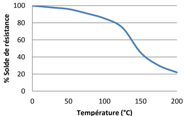
Essais de cisaillement en température réalisés sur l'acier doux. Les échantillons sont entièrement polymérisés avant d'être mis en température pendant 30 minutes avant réalisation des essais.
