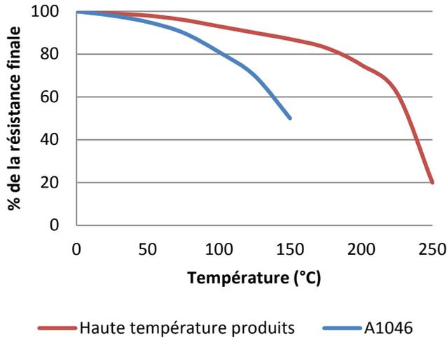
*"Dureté à chaud" l'évolution du couple de rupture en fonction du temps sur des boulons M10 en acier zingué selon la norme ISO 10964. Polymérisation de 24 heures à 23°C. Puis conditionnement de 30 minutes à des températures montrées dans le graphique.*
