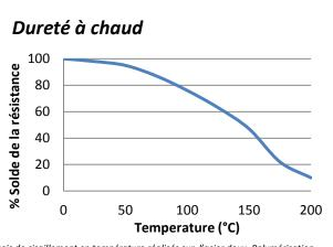
Essais de cisaillement en température réalisés sur l'acier doux. Polymérisation complète à température ambiante, puis mise en température durant 30 minutes avant réalisation des essais.
