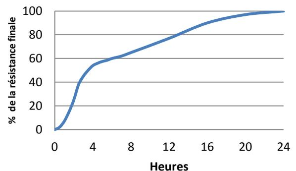
Ce graphique montre un développement typique de la résistance des composants collés à 23°. Une augmentation de la température de 8° réduira de moitié le temps de polymérisation. Les plus basses les températures, le plus long le temps de polymérisation.
