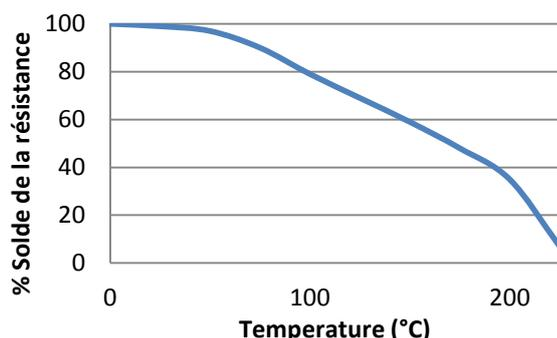
Essais de cisaillement en température réalisés sur l'acier doux. Polymérisation complète à température ambiante, puis mise en température durant 30 minutes avant réalisation des essais.
