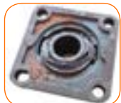
NETTOYER LA ROUILLE ET LES IMPURETÉS AVEC UNE BROUSSE MÉTALLIQUE
