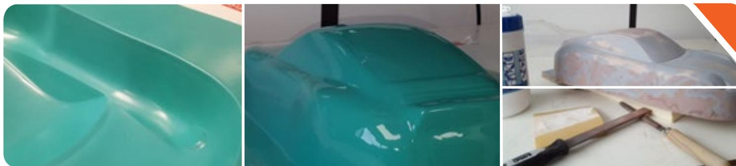
Le Gel-coat « ou couche de surface », est une résine utilisée comme couche de la finition et protection de la surface visible d'un modèle ou d'un outillage lorsque la résine seule ne peut assurer ces fonctions :
