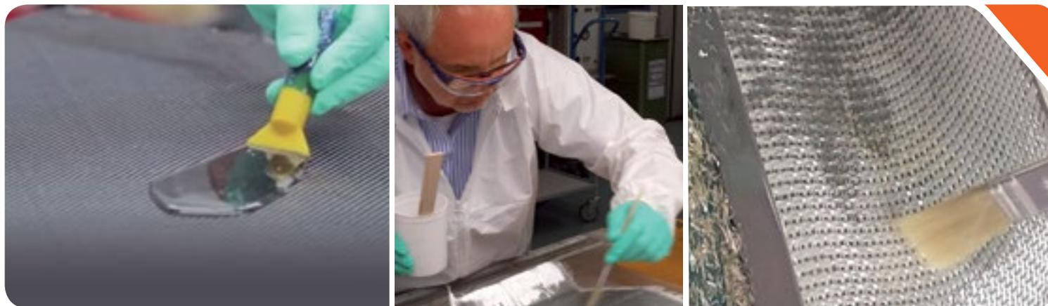
Les résines de stratification de la gamme RenLam® sont idéales pour la réalisation d'outillages en composite.
