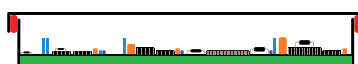
Figure 02 Étanchéité du couvercle du boîtier électronique par un joint ► Protection contre les impacts, poussières et débris
