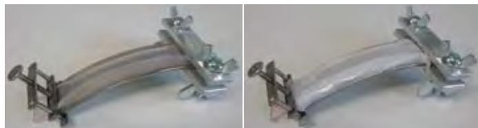
Les éprouvettes dont la forme et les paramètres étaient conformes à la norme DIN ISO 527-2 Type 1B ont été placées sur le support d'un rayon de 140mm. Les échantillons ont été maintenus en contact avec la graisse pendant 7 jours à 80°C.
