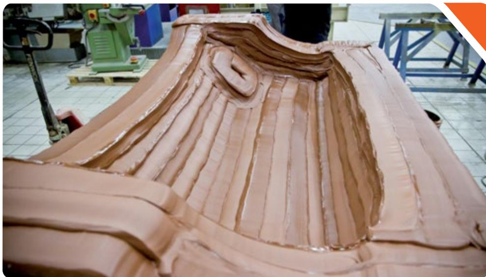
Les pâtes extrudables en machine et pâtes à application manuelle sont des systèmes bi-composants destinés à la réalisation de modèles, maquettes, moules ou à leurs assemblages et leurs réparations. Leur ratio de mélange est simple (100/100) et leur utilisation apporte un gain de temps et de matière non négligeables.
