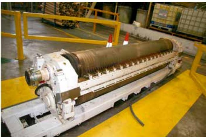
Les rouleaux interchangeables utilisés sur la ligne de SAICA Pack sont fournis en location-vente par le fabricant allemand BHS Corrugated Maschinen- und Anlagenbau GmbH, qui stipule l'utilisation de graisse PFPE/PTFE Krytox™, ainsi qu'une autre, pour ses rouleaux d'onduleuse.
