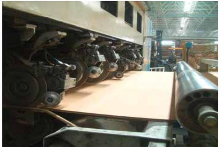
Les graisses PFPE/PTFE Krytox™ sont devenues la norme pour lubrifier les roulements des rouleaux préchauffeurs des onduleuses simple face et des équipements associés. Les lubrifiants Krytox™ contribuent à éliminer les défaillances prématurées des rouleaux liées à une mauvaise lubrification. Sur les onduleuses simple face lubrifiées par de la graisse Krytox™, le changement des rouleaux est bien plus facile et bien plus rapide.
