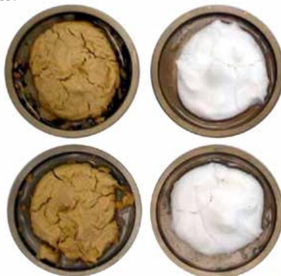
Différence de volatilité : des échantillons de graisse d'environ 20 grammes (lubrifiant sans PTFE à gauche, Krytox™ à droite) avant et après un test au four à 180 °C. On voit clairement que l'huile du lubrifiant sans PTFE s'est évaporée, engendrant un changement d'aspect, de couleur et d'homogénéité.
